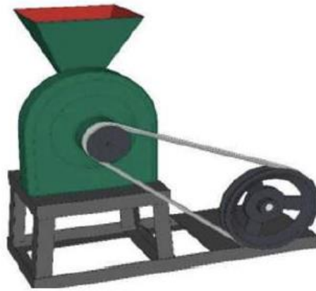
Gambar 10.7. Skema desain mesin giling kopi [145]
