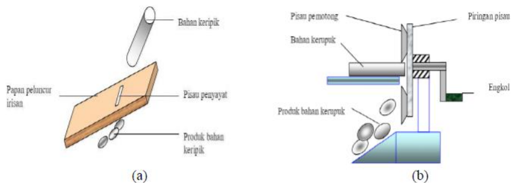
Gambar 4.2. (a) Pengiris singkong dengan papan pisau, (b) Mesin pengiris singkong manual [47]
