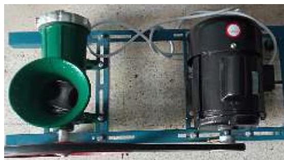
Gambar 9.10. Alat penggiling kacang [129]
