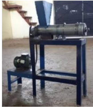
Gambar 7.22. Mesin peras santan penekan horisontal [102]
