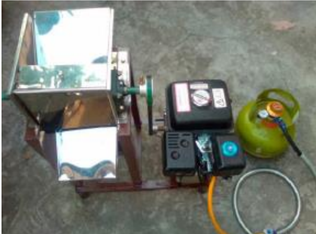
Gambar 7.19. Mesin pamarut kelapa berbahan bakar gas [99]
