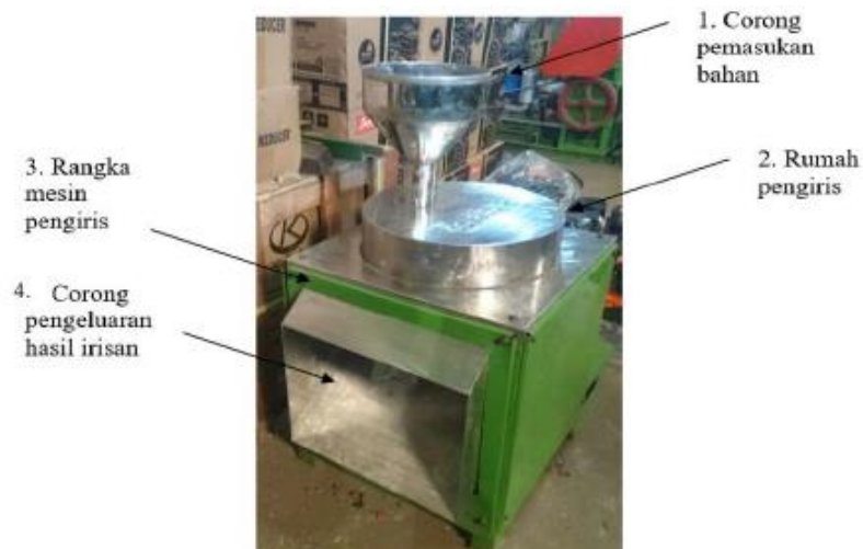
Gambar 4.7. Perajang singkong tipe vertikal [56]
