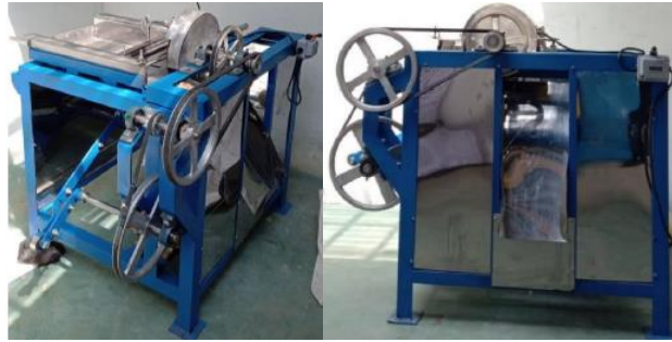
Gambar 8.12. Foto mesin pemotong adonan kerupuk [116]
