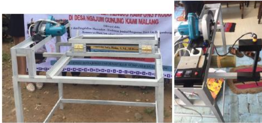
Gambar 12.5. Pemotong bambu otomatis [161]
