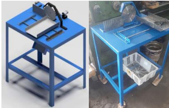
Gambar 8.14. Desain dan foto mesin potong adonan kerupuk [119]
