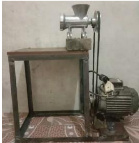
Gambar 11.4. Mesin penggiling daging ayam [152]
