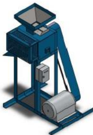
Gambar 4.13. Desain pamarut gapplek basah [63]
