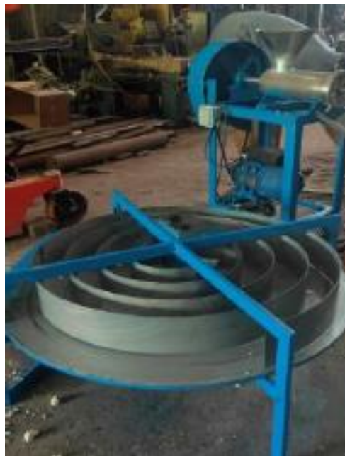
Gambar 9.8. Alat pencetak tahu bulat [127]
