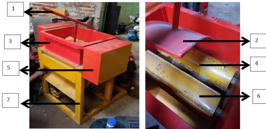
Gambar 7.8. Desain pengupas sabut kelapa asimetrik [87]
