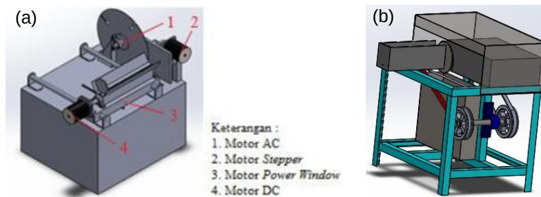
Gambar 9.13. Desain mesin perajang tempe otomatis: (a) [132], (b) [133]
