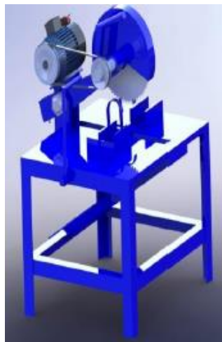
Gambar 12.6. Desain mesin pemotong lidi tusuk sate [162]
