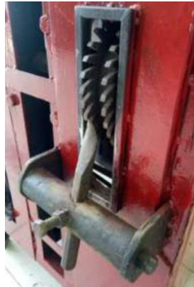
Gambar 7.14. Pisau pengupas tempurung kelapa [91]
