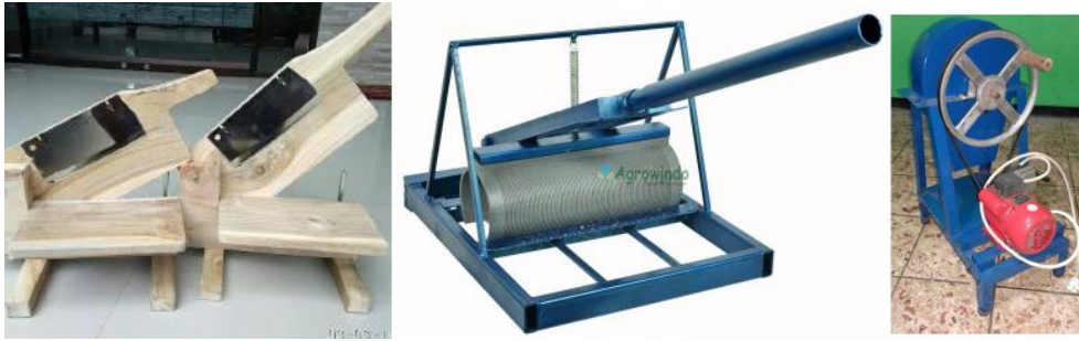
Gambar 8.8. Jenis alat potong adonan kerupuk [112]
