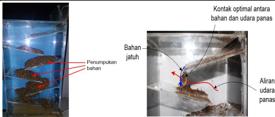
Gambar 2. Model laboratorium ViGOT; tanpa getaran terjadi penumpukan bahan (kiri); ViGOT berfungsi sempurna (kanan).
