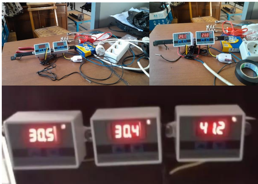
Gambar 15. Perangkaian termostat dan sensor (atas). Pembacaan suhu operasional (bawah) untuk termostat (kanan), sensor suhu 1 (tengah), dan sensor suhu 2 (kiri)
