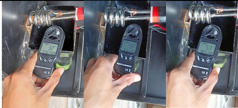
Gambar 16. Pengukuran kecepatan output blower, rendah (kiri), sedang (tengah), dan tinggi (kanan)
