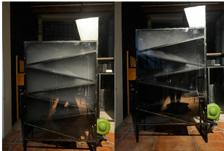
Gambar 8. Pengujian kinerja hembusan blower pada kecepatan minimum. Selisih waktu posisi kiri dan kanan 2 detik.
