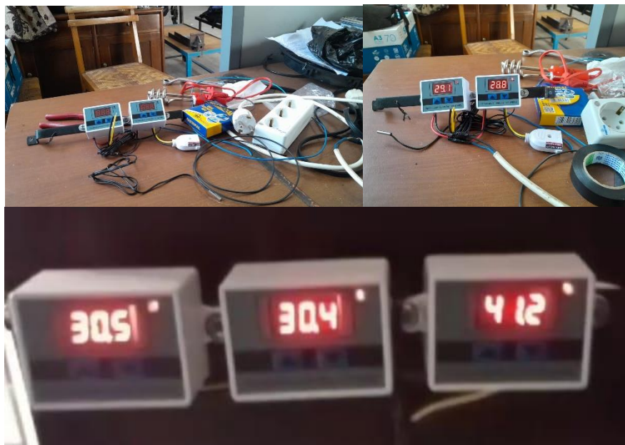
Gambar 6. Perangkatian termostat dan sensor (atas). Pembacaan suhu operasional (bawah) untuk termostat (kanan), sensor suhu 1 (tengah), dan sensor suhu 2 (kiri)
