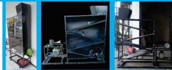
ViGOT v.01 kiri, vibrator pegas - sama dengan model laboratorium; v.02 (tengah, vibrator pengungkit); dan v.03 (kanan, vibrator engkol pengungkit)
