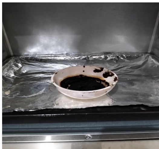
Gambar 8. Proses pengeringan hydrochar dengan Impregnasi KOH
