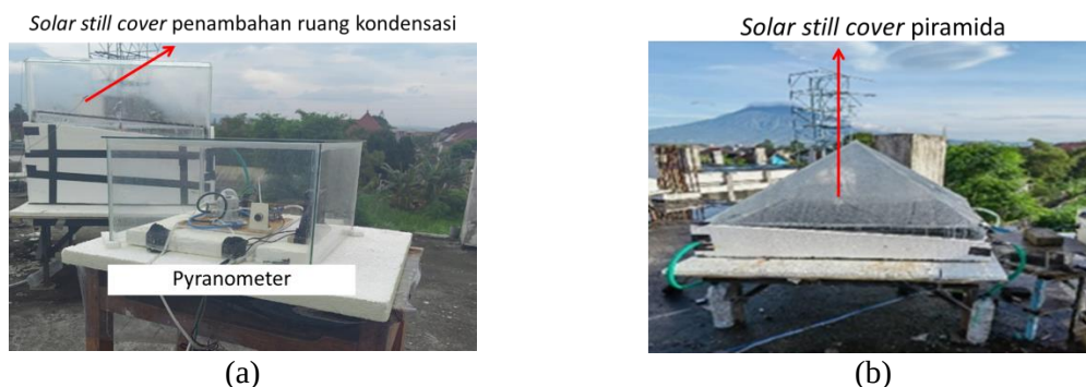
Gambar 2. (a) Solar still dengan cover penambahan ruang kondensasi, (b) Solar still dengan cover piramida
