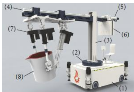
Gambar 6.22. Robot penuang bergerak tipe rangka hibrida. (1) landasan 4WD. (2) Perangkat slewing. (3) Perangkat pengangkat. (4) perangkat maju. (5) Perangkat mundur. (6) Perangkat penyeimbang. (7) manipulator paralel. (8) Efektor akhir. [51]
