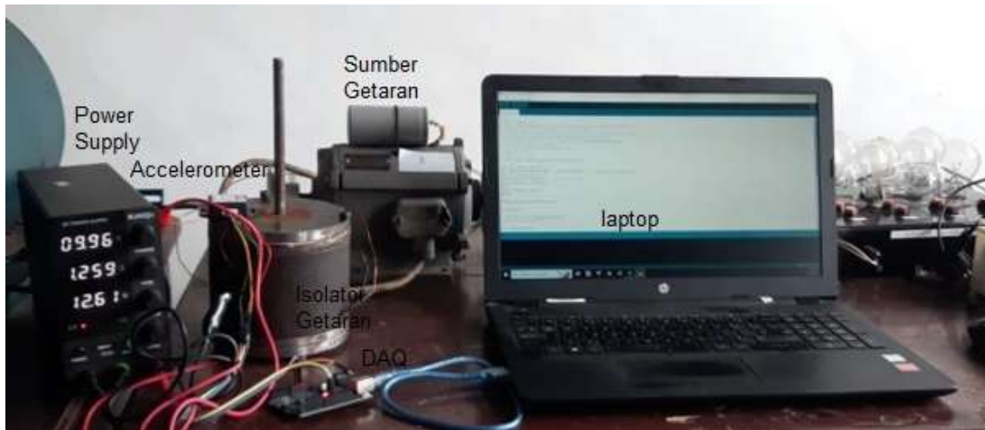
Gambar 13. Test Rig isolator getaran secara lengkap
