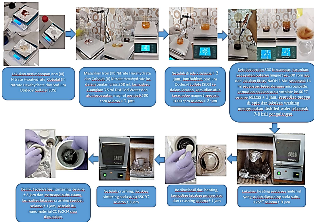
Gambar 4. Langkah sistesis Nano Material Iron (III) Oxide dan Cobalt Ferrite
